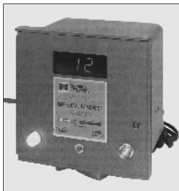
شکل ۸-۵ نمونه‌ای از تسترهای الکترونیکی جهت اندازه‌گیری چگالی دود
