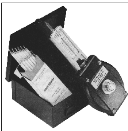
شکل ۵-۵ نمونه‌ای از دستگاه اندازه‌گیری مونواکسیدکربن به روش شیمیایی
