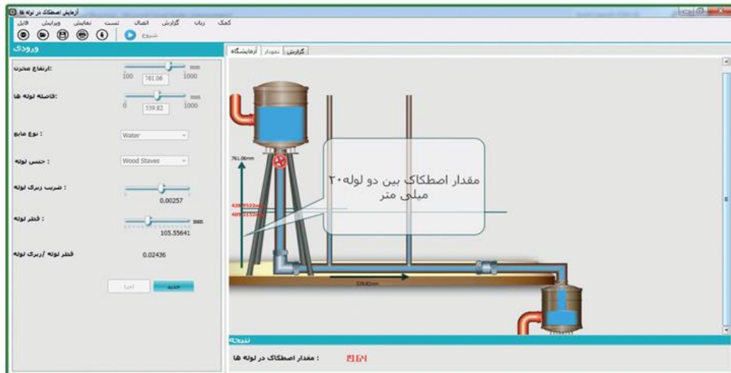
شبیه ساز آزمایشگاه مکانیک سیالات ، آزمایش اصطکاک در لوله ها
